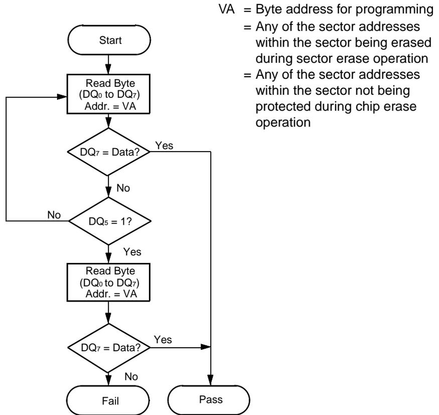
**Note:** DQ<sub>7</sub> is rechecked even if DQ<sub>5</sub> = "1" because DQ<sub>7</sub> may change simultaneously with DQ<sub>5</sub>.
