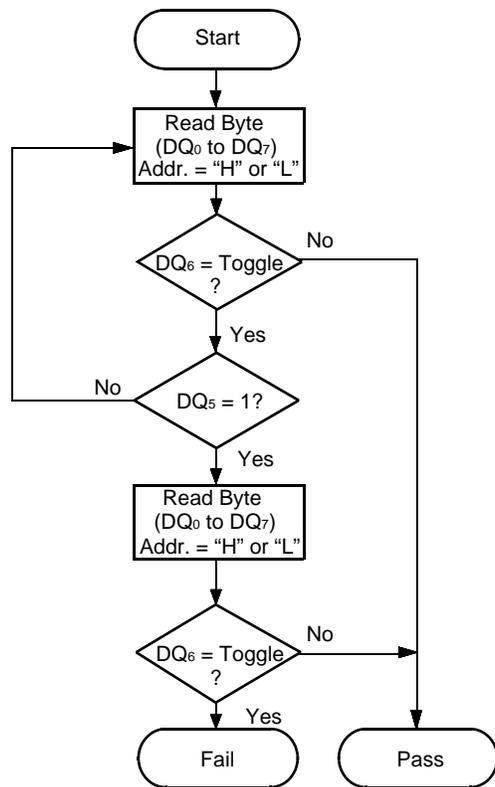
**Note:** DQ<sub>6</sub> is rechecked even if DQ<sub>5</sub> = "1" because DQ<sub>6</sub> may stop toggling at the same time as DQ<sub>5</sub> changing to "1".
